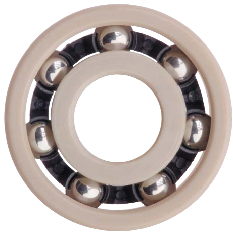
Bild PM1507-02: igus GmbH, Köln Kunststoff-Rillenkugellager aus „iglidur A500“ – schmiermittel- und korrosionsfrei, temperaturbeständig bis 150 °C.
